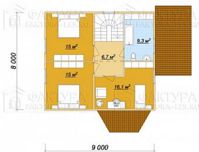
План второго этажа
